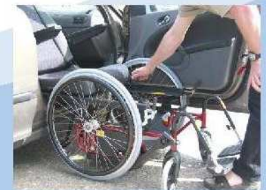
Carony avec des roues de 24" de diamètre que l'on retire facilement. L'embase roulante se range ensuite dans le coffre du véhicule.
