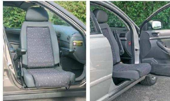
Le plateau tournant Turnout (ici avec les glissières de Carony sur les côtés) est combiné à un siège de voiture à assise basse (le siège BEV) de manière à conserver la même hauteur par rapport au plafond de l'habitacle. Des accoudoirs ont été ajoutés au siège présenté ci-dessus.
