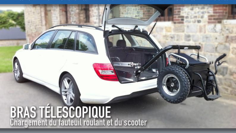
Le bras télescopique est un dispositif d'aide au chargement d'un fauteuil roulant ou d'un scooter dans le coffre d'un véhicule.
