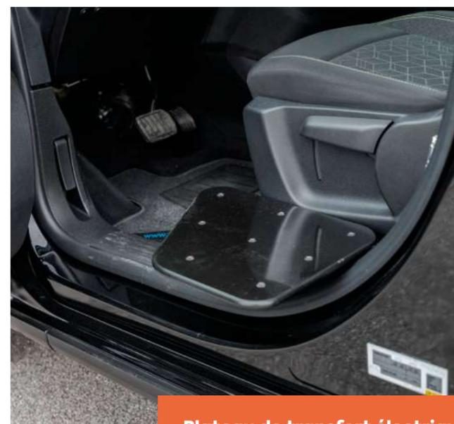
Plateau de transfert électrique pour châssis haut
