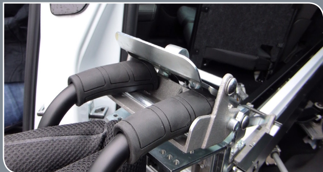
MAINTIEN DU FAUTEUIL PAR LEVIER «MÂCHOIRE»
