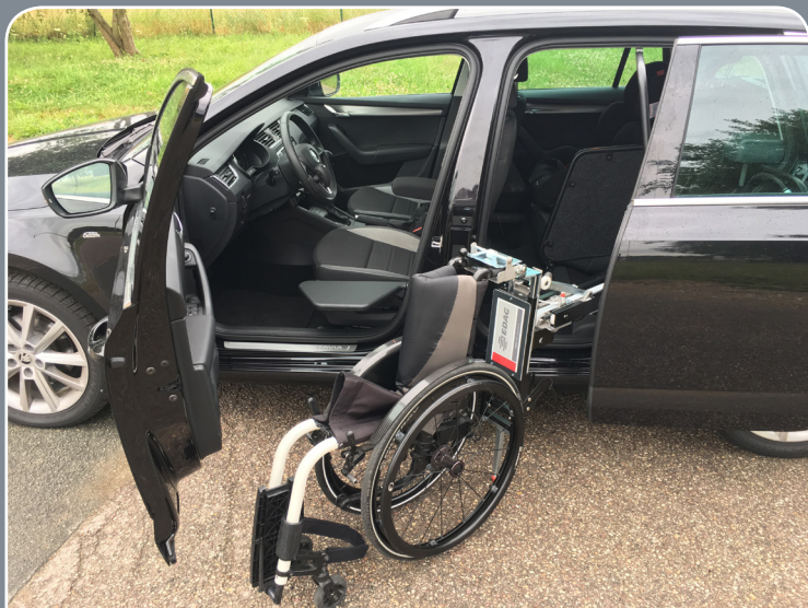
BRAS ROBOT EDAG ET PORTE ESCAMOTABLE
