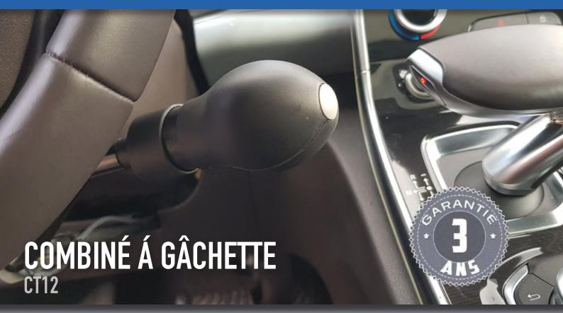
Le combiné accélérateur-frein CT12 est un dispositif permettant d'accélérer et de freiner manuellement depuis un levier unique situé derrière le volant, à gauche ou à droite. L'accélération s'obtient en faisant coulisser avec son pouce une large bague appelée «gâchette». Le freinage s'opère en poussant le levier vers le tableau de bord. Le CT12 peut être installé sur tous types de véhicules équipés d'une boîte de vitesse automatique.
