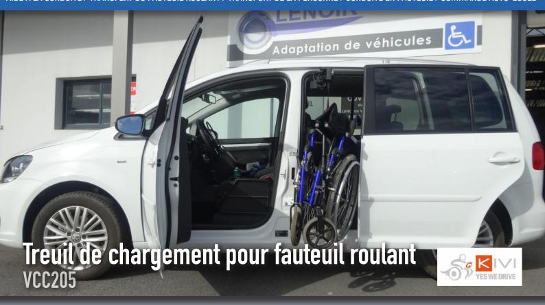
Le treuil de chargement pour fauteuil roulant est un bras articulé. Il permet le chargement d'un fauteuil manuel, plié, dans les voitures à 5 portes. Il est fixé à la partie supérieure du montant, et se démonte très facilement. La rotation du bras articulé à l'intérieur et à l'extérieur du véhicule est manuel; tandis que la montée et la descente du fauteuil sont électriques, actionnées par une télécommande ou un interrupteur.
