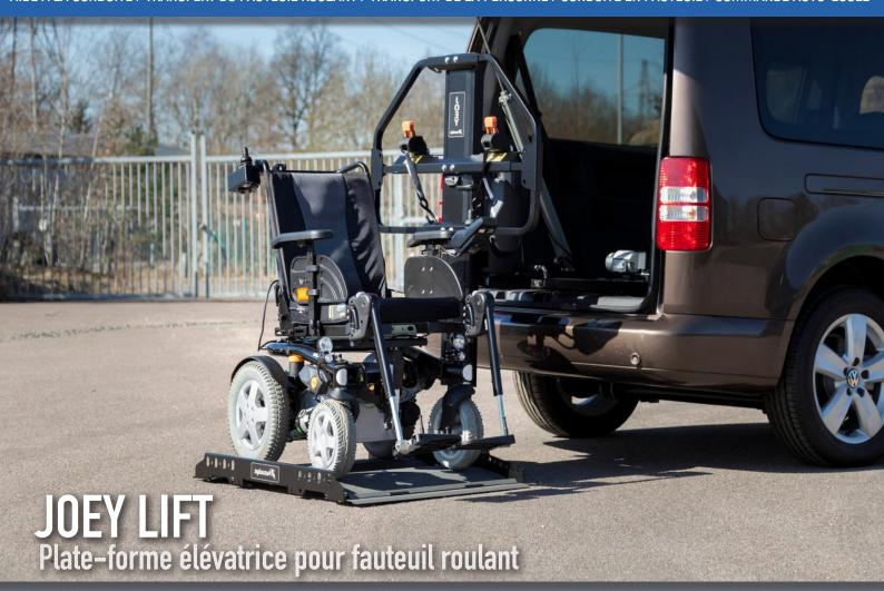
La plate-forme élévatrice Joey Lift offre une solution de transfert simple conçue pour les fauteuils roulants, manuels ou électriques, et les scooters. Une fois le fauteuil ou le scooter positionné sur le plateau, une simple pression sur la télécommande filaire fournie avec la plate-forme vous permettra de le soulever et de le ranger dans votre véhicule.
